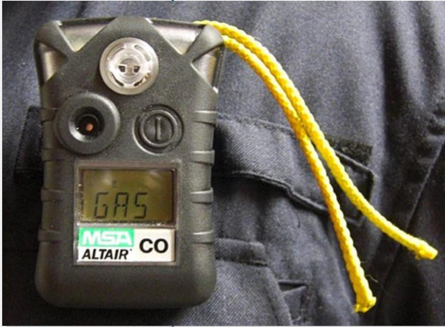
Der CO-Warner wird an der Einsatzkleidung getragen und löst aus, wenn ein bestimmter Grenzwert erreicht ist.
