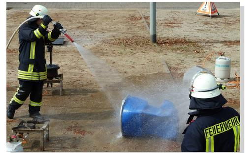
**Mit einem Schlag zog sich das eigentlich stabile Fass völlig zusammen. „Das geschieht durch das rasche Abkühlen des zuvor erwärmten Inhalts durch das Löschwasser“, erklärte Arndt Preußner sein Großexperiment**
