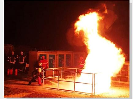
vielmehr mit dem Wasserstrahl einzufangen, um den Zugang zum Absperrhahn zu ermöglichen. Hierfür war ein geschickter Umgang mit dem Hohlstrahlrohr bei geringer Wassermenge entscheidend. Besonders in geschlossenen Räumen sollte das Feuer keinesfalls gelöscht werden, da sonst das Gas in dem Raum ein explosionsfähiges Gemisch erzeugen kann.
